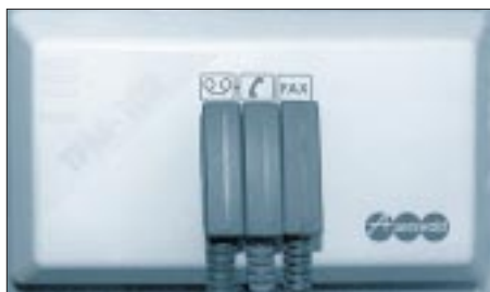
Bild 1: Ansicht eines handelsüblichen Telefon-/Faxmodem-Umschalters Foto: Autor
