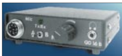
GD 16 BT: Schnelle Umschaltung mittels kleinem Hebel-schalter
